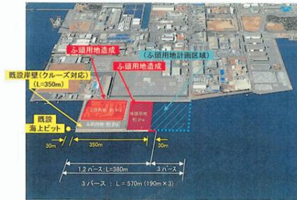
**Q1. 三河港蒲郡地区で、現在整備を進めている水深11mの岸壁は、完成自動車の輸出拠点やクルーズ船の寄港地として産業、観光の両面でこの地域を支えている。現在、岸壁は350mが完成し、引き続き30mの延伸工事が進められており、また、岸壁の背後においては、輸出する完成自動車を自動車運搬船に積み込むためのふ頭用地を拡張している。その進捗状況について伺う。**
